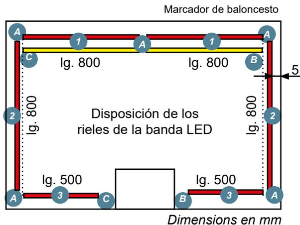
Fije los rieles (usando el adhesivo) hacia el exterior de la canasta (banda LED visible para los jugadores)
