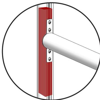
Fijación del travesero reforzada mediante un elemento de acero ubicado en el interior del poste
