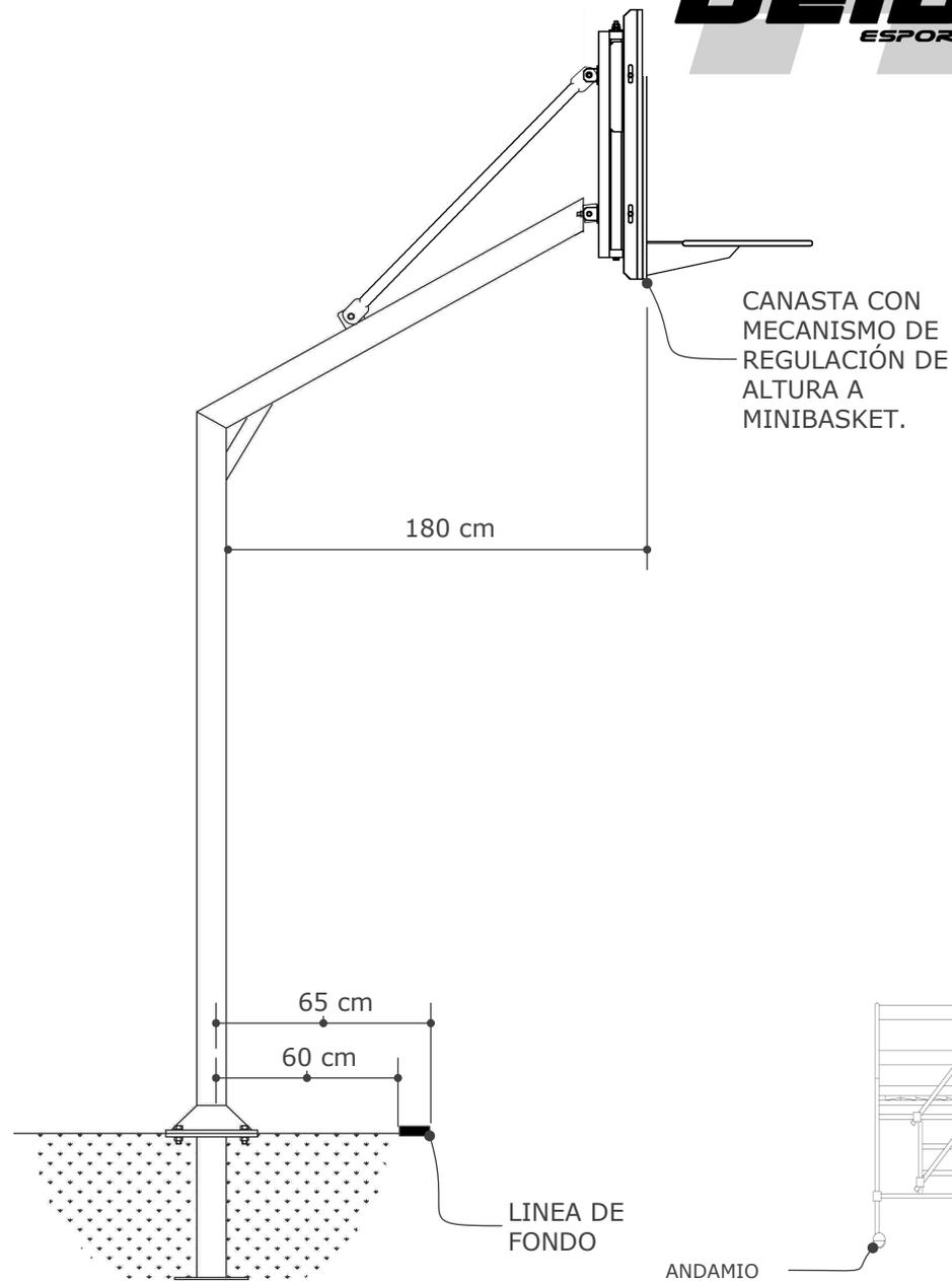
CANASTA CON MECANISMO DE REGULACIÓN DE ALTURA A MINIBASKET.
