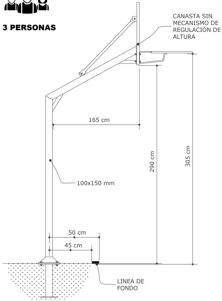
CANASTA SIN MECANISMO DE REGULACIÓN DE ALTURA
